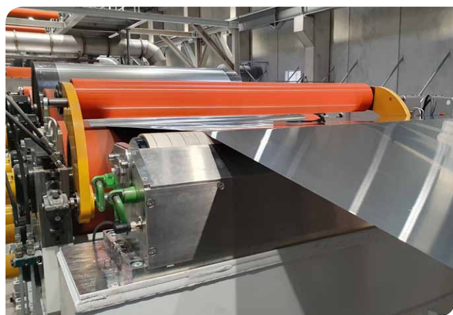
Оборудование FIMI, Италия, алюминий, линия выравнивания натяжения
