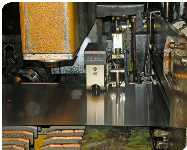
C. D. Waelzholz (завод Wickede) - Германия, биметалл, стан холодной прокатки - контактный толщиномер, используется для оперативной калибровки рентгеновского толщиномера
