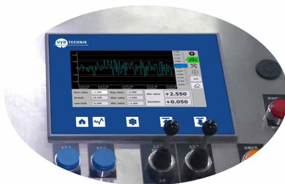
Сенсорная панель вмонтирована в панель оператора
