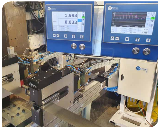
Тепнессо, Италия, биметалл, прокатный стан - однолинейный + сканирующий измеритель толщины
